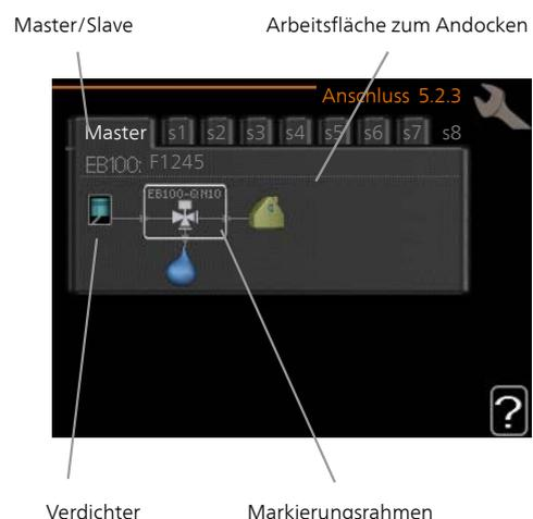
**Master/Slave:** Hier stellen Sie ein, für welche Wärmepumpe die Anschlusseinstellung vorgenommen werden soll (bei einer einzelnen Wärmepumpe im System wird nur der Master angezeigt).
